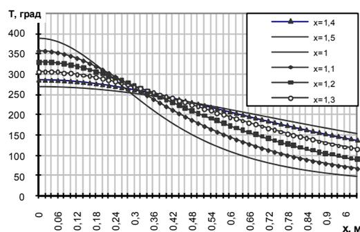
Рис. 3. Температурные поля струи в различных сечениях
