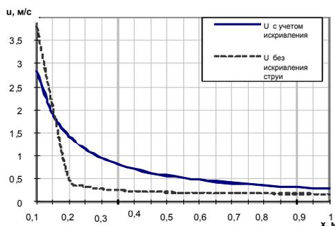
Рис. 2. Изменение скорости вдоль оси струи с учетом искривления струи и без него
